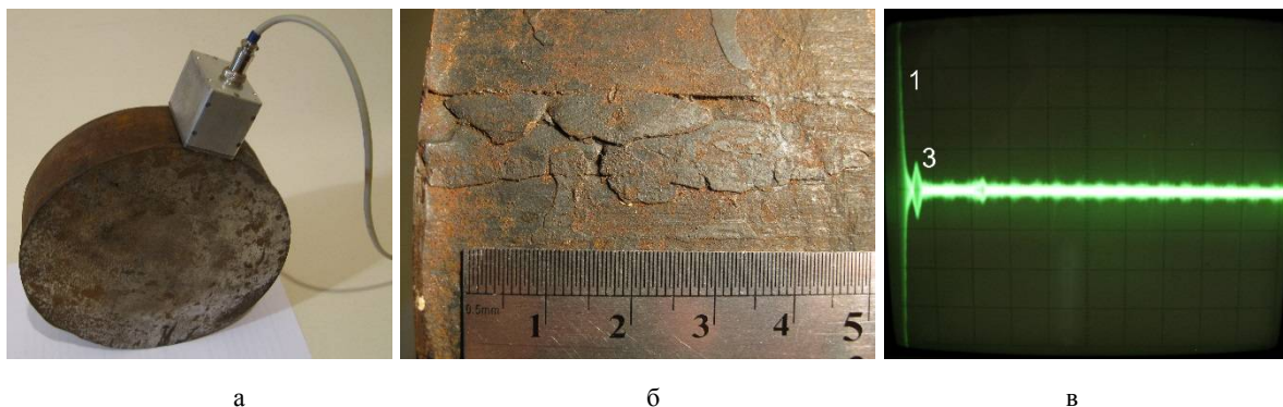
Рис. 6 – Ультразвуковой контроль образца: а – заготовка круглого сечения; б – фото естественного дефекта; в – реализация контроля с индикацией от этого дефекта
